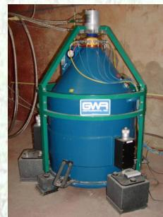
Gravimètre à supraconductivité : les variations temporelles de la pesanteur sont mesurées par la force nécessaire à garder en équilibre une sphère en lévitation dans un champ magnétique.
